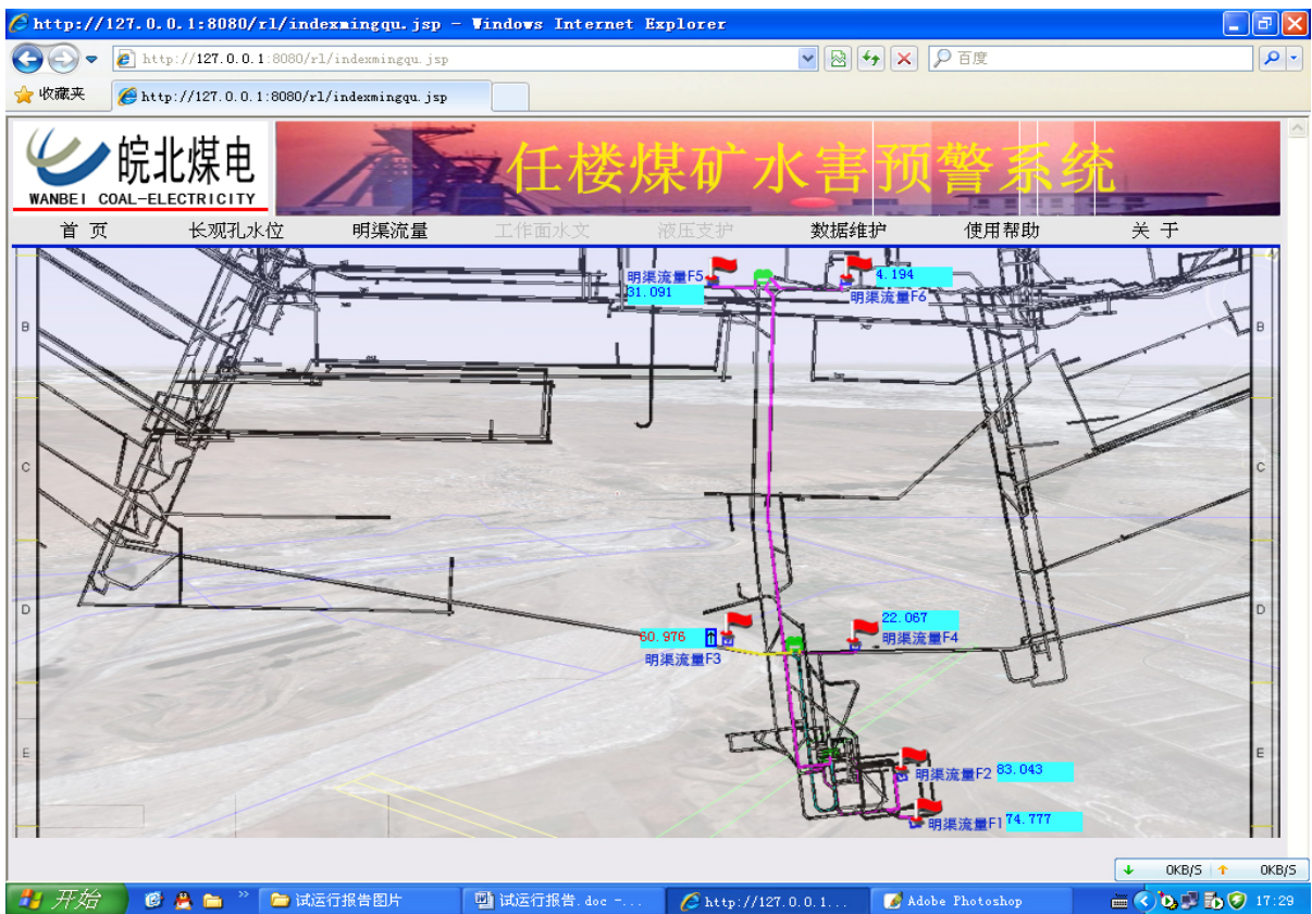
矿井井下综合水在线监测及预警系统实时界面
