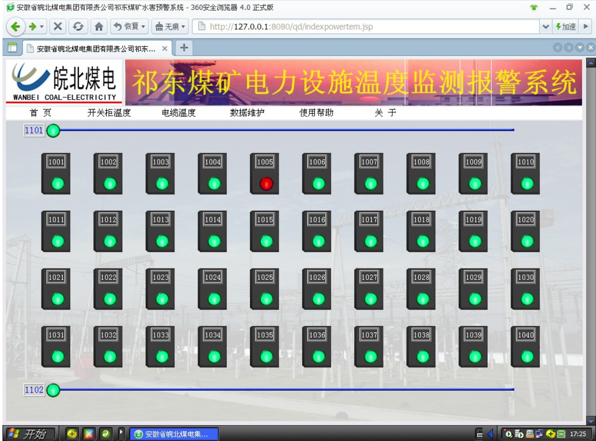
电力设施温度在线监测及预警系统实时界面
