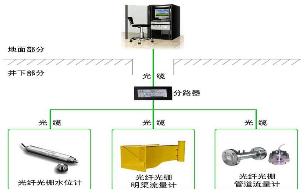
井下综合水在线监测系统结构图
