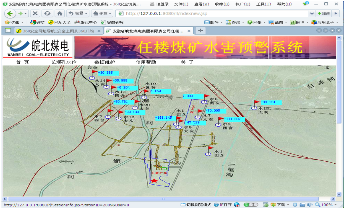
矿井水文观测孔水位遥测及预警系统实时监测界面
